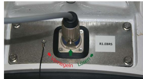
**Der Stecker darf bei eingeschalteter Steuerspannung gesteckt und gezogen werden jedoch nicht, wenn die Taste des Betätigers gedrückt ist.**
