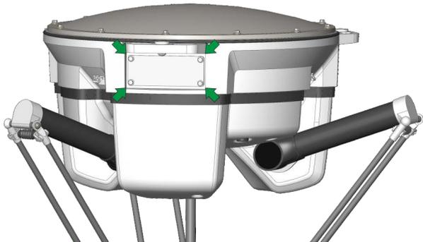
Lösen sie hierzu die vier Schrauben der Blindplatte.
